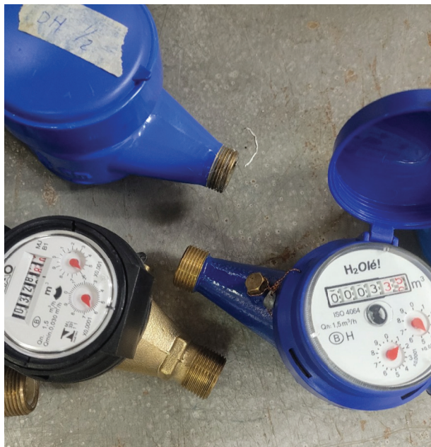
Medidores de agua potable
