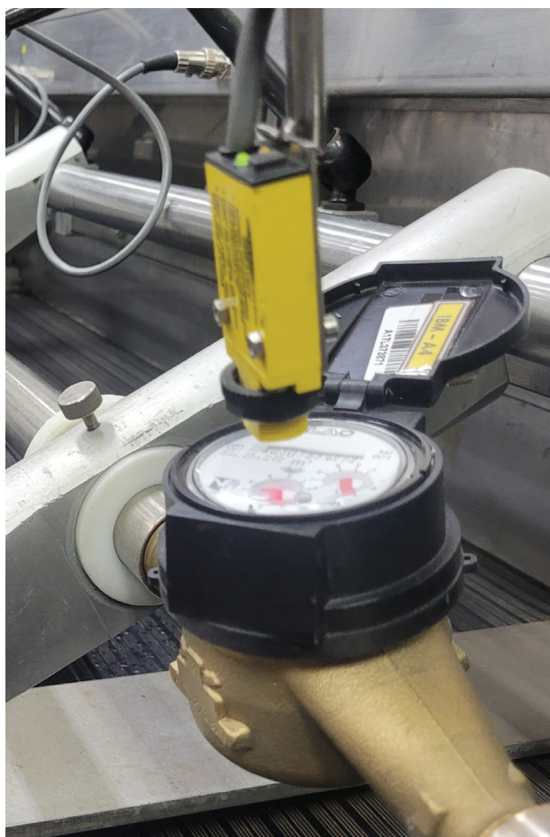
Bancada de sensores para medidores de agua
