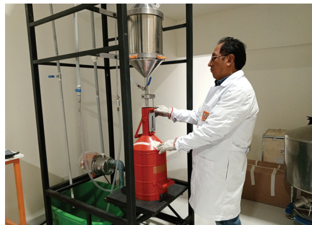
El Laboratorio de Grandes Volúmenes brinda servicios de calibración para recipientes volumétricos
