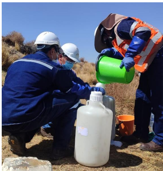
Imagen 1. Toma de muestras de agua residual.
