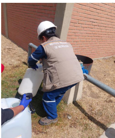
Imagen 1. Toma de muestra del ítem de ensayo de parámetros fisicoquímicos.
