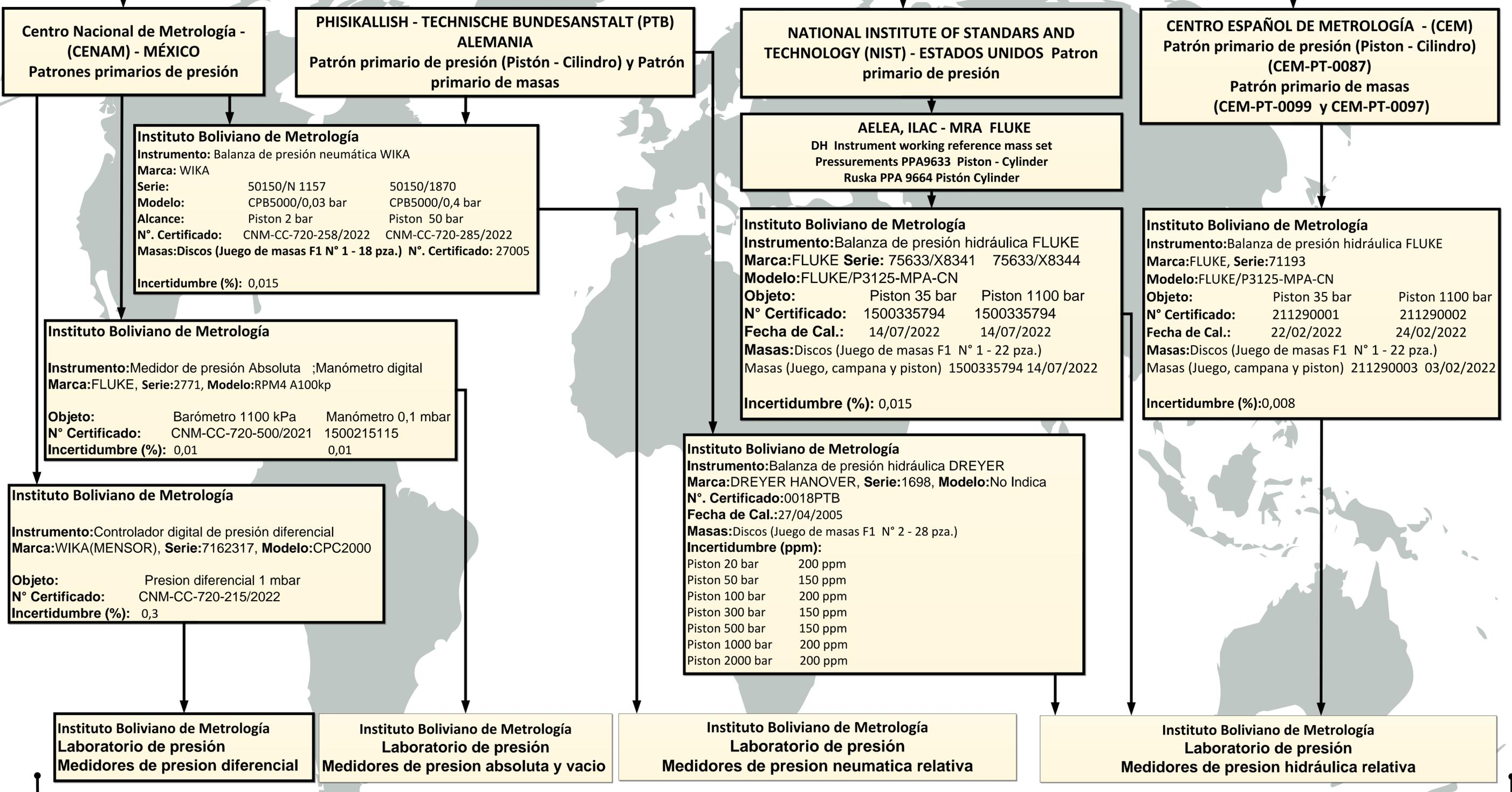
CALIBRACIÓN DEL MEDIDORES DE PRESIÓN RELATIVA Y VACIO, DIFERENCIAL Y ABSOLUTA.
