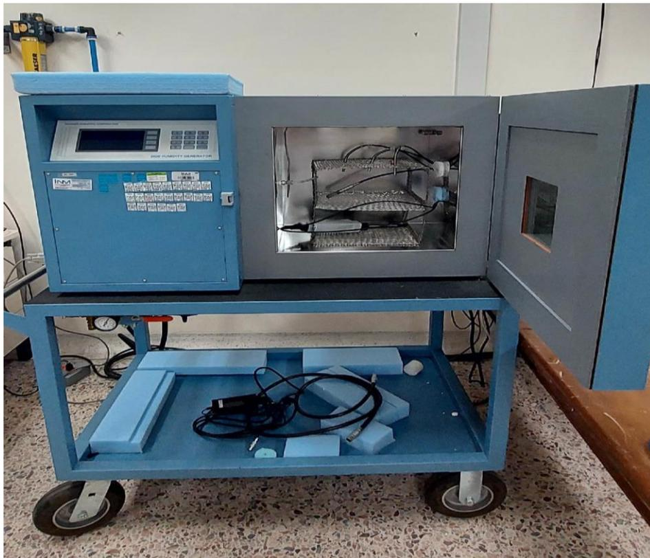
Figura 8. Calibración de patrones de Humedad Relativa del Laboratorio de Humedad - IBMETRO
