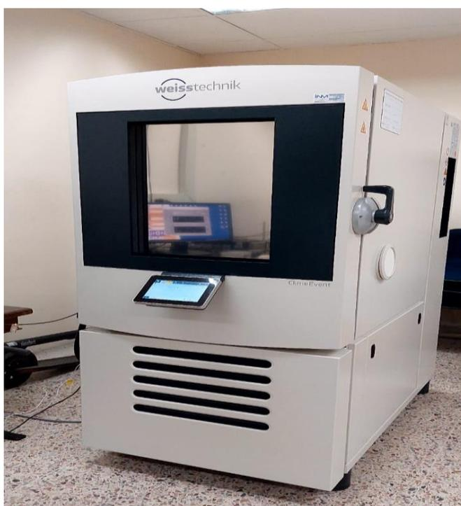
Figura 3. SISTEMA DE MEDICION CAMARA CLIMATICA
