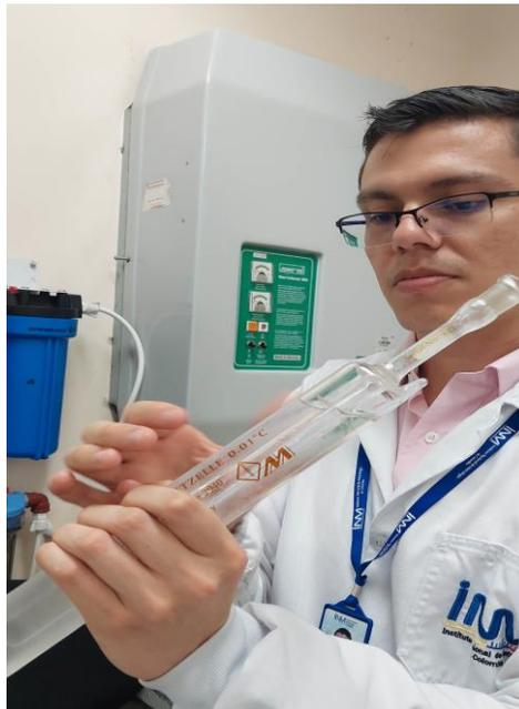
Figura 9. Realización de la celda de Punto triple de agua WTR
