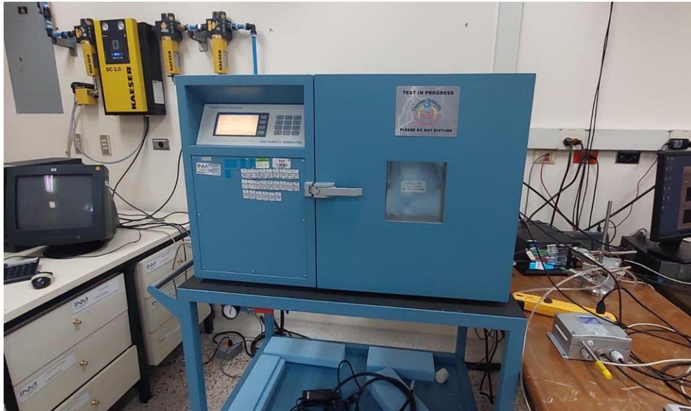
Figura 4. SISTEMA DE MEDICION CAMARA GENERADORA DE DOS PRESIONES
