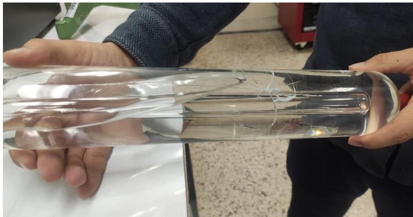
**Figura.** Celda del Punto Triple del Agua quebrada por el efecto del golpe de hielo interno
