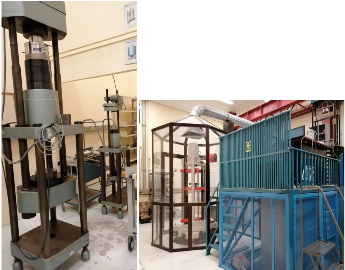
Figura 6. Patrón primario de transferencia de fuerza y patrón primario de pesos muertos de fuerza
