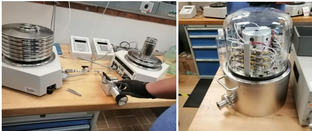
Figura 2. Sistema de calibración de patrones primarios neumático por el método de flotación cruzada
