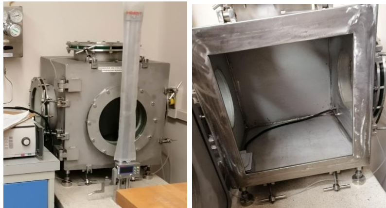
Figura 4. Cámara de Vacío
