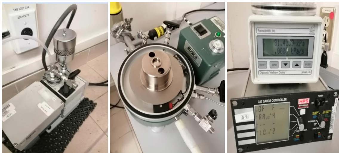
Figura 2. Patrón primario de presión neumática, bomba de alto vacío y controlador de presión
