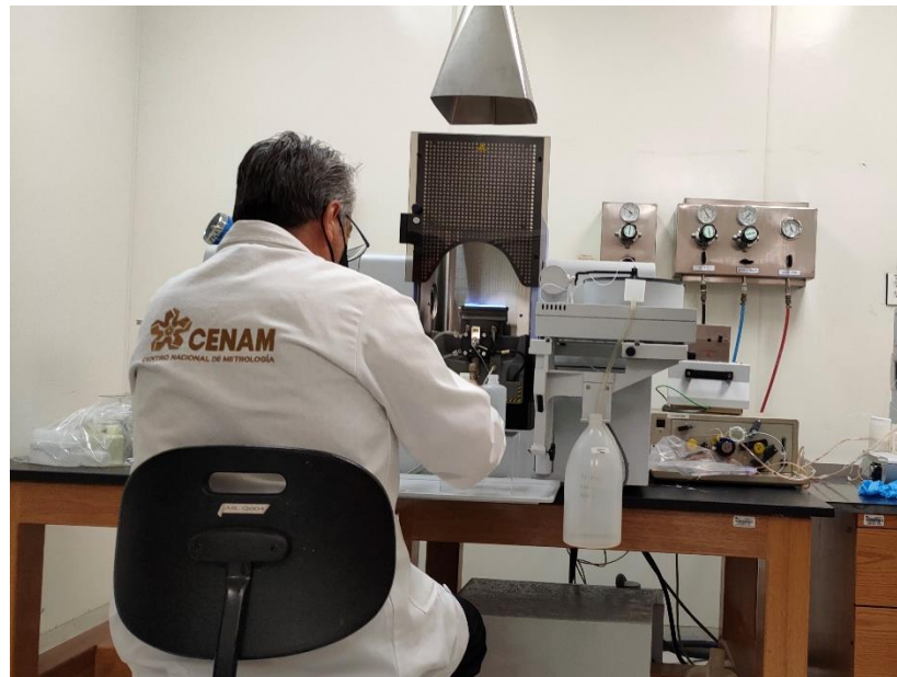
El instructor Pedro Ramirez realizando la medición de Cu y Fe en el espectrofotómetro de absorción atómica – técnica de flama.
