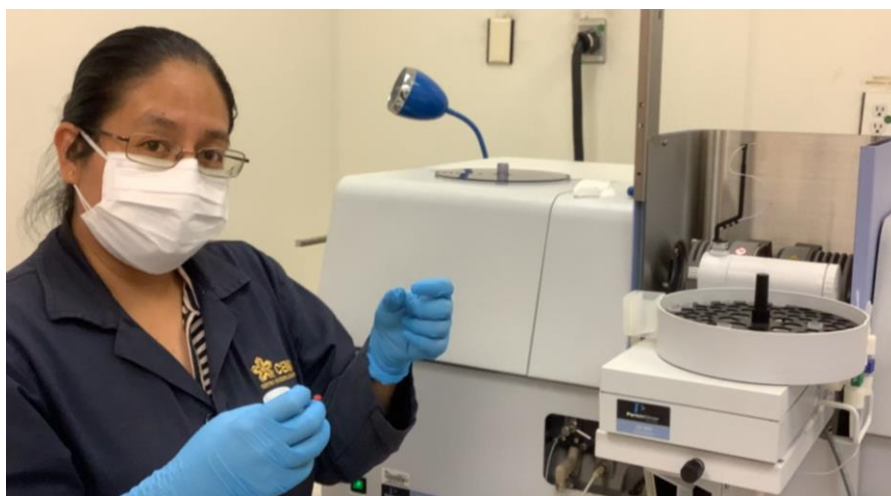
La instructora Itzel Santiago realizando la medición de Pb y Cd en el espectrofotómetro de Absorción Atómica – técnica de atomización electro térmica.
