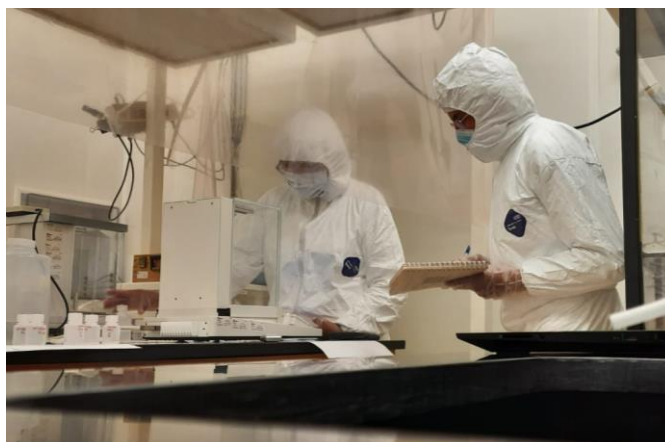
Preparación de muestras y curva de calibración de Pb y Cd mediante pesada por diferencia en el cuarto limpio. Nótese el uso de indumentaria especial para evitar el riesgo de contaminación en las muestras y soluciones calibrantes.
